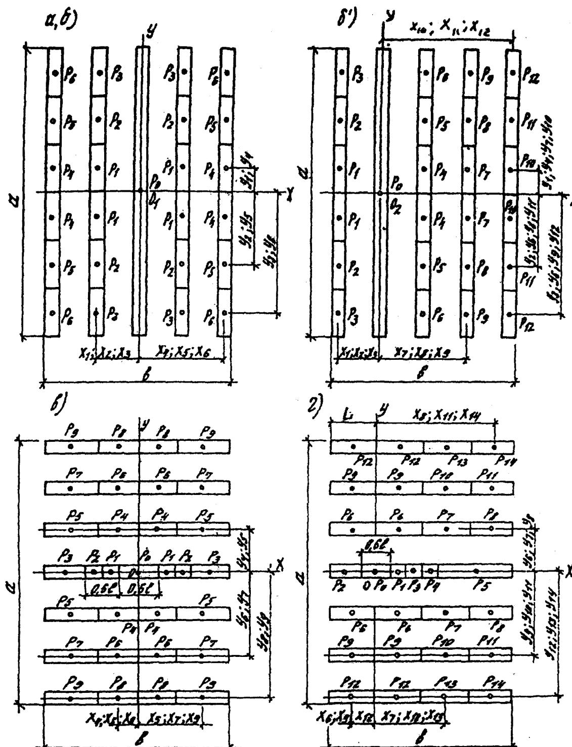
а, в – нагрузки, равномерно распределенные по длине параллельных следов (от прокладок под тяжелые предметы, от штабелей цилиндрических валов и др.) при  $b \leq 4,4l$ ;  $a > b$ ; б, б' – то же, при  $b > 4,4l$ ;  $a > b$
